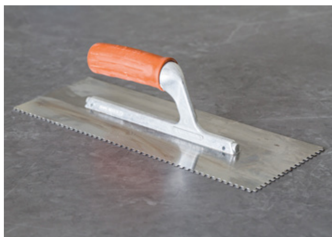
Spatola a denti inclinati per stesura adesivo sul supporto e a denti quadrati per la stesura adesivo sul retro lastra
