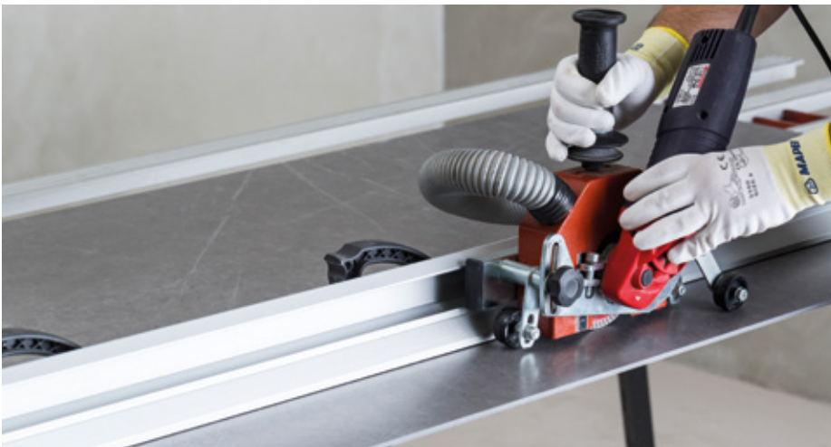
Esecuzione taglio lineare tramite smerigliatrice
