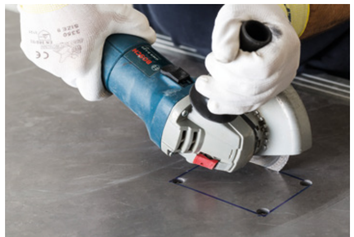
Sequenza per eseguire fori rettangolari
